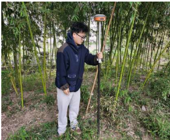
现场 RTK 定点
